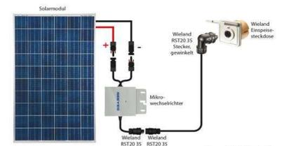
Aufbau einer Balkonkraftanlage
